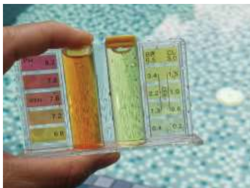
ภาพที่ 3.5.4-1 วิธีการตรวจวัด pH และ Free Chlorine
