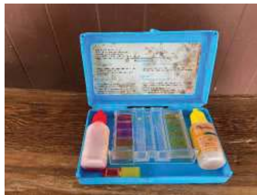
ภาพที่ 3.5.4-1 วิธีการตรวจวัด pH และ Free Chlorine
